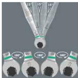
Gracias al hecho de que el lado de la boca se encuentra doblado en un ángulo de 7,5°, y además con ayuda de la geometría de doble hexágono, más una forma de aplicación adaptada (posicionar – atornillar – voltear – volver a posicionar – atornillar – voltear, etc.) incluso es posible solucionar aquellas situaciones en las cuales
