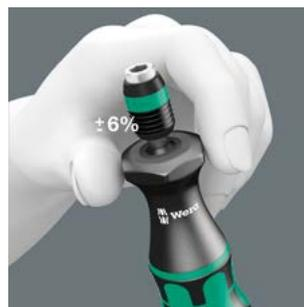
Questi giravite dinamometrici vengono forniti con una coppia preimpostata. Ciò risulta essere ideale per tutti i lavori che richiedono sempre la stessa coppia: coppia preimpostata da 0,3 Nm a 4,0 Nm (regolabile da 0,3 Nm a 8,8 Nm), tre impugnature diverse, precisione ± 6 %, cambio degli inserti ultrarapido grazie al porta-inserti
