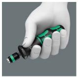
Manche Kraftform multicomposants associant zones dures et tendres, pour des vitesses de travail élevées ainsi qu'un ménagement de la surface de la main. Série 7400 Tournevis dynamométriques Kraftform, avec valeur préréglée en usine (0,3-3,0 Nm), avec mandrin à serrage rapide Rapidaptor, taille de manche 105 mm
