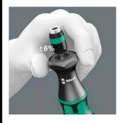
Ces tournevis dynamométriques sont livrés avec une valeur de couple préréglée, ce qui est idéal pour toutes les applications qui nécessitent constamment le même couple. Couple préréglé de 0,3 Nm à 4,0 Nm (ajustable de 0,3 Nm à 8,8 Nm), trois manches différents, précision de mesure de ± 6 %, échange éclair des
